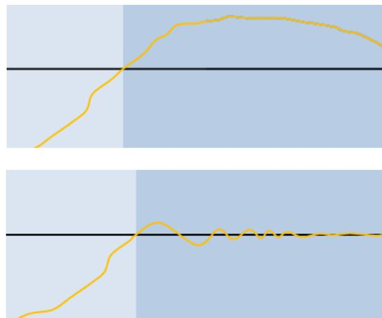
**Figure 4.** Effet de réinitialiser ou non l'erreur accumulée après saturation.
