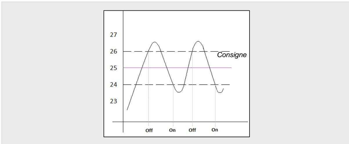
Le problème de ce type de contrôle, en comparaison avec d'autres systèmes plus avancés, est l'oscillation permanente autour de la température de consigne qui agit de manière directe sur la consommation énergétique et sur le confort.
