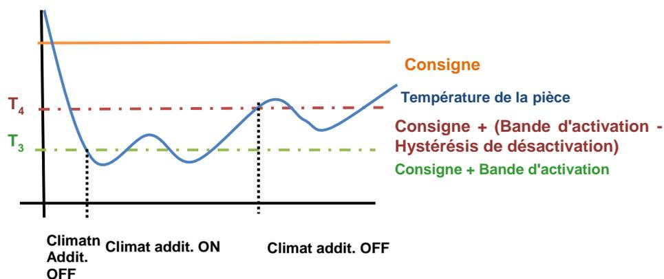
Figure 6. Activation et désactivation du système additionnel en mode chauffage.
