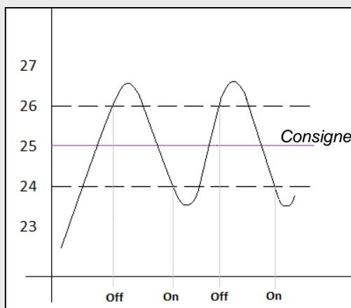
Le principal problème de ce type de contrôle, en comparaison avec d'autres systèmes plus avancés, est l'oscillation permanente autour de la température de consigne qui agit de manière directe sur la consommation énergétique et sur le confort.
