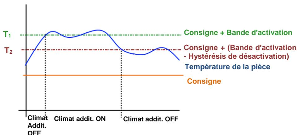
Figure 5. Activation et désactivation du système additionnel en mode refroidir.
