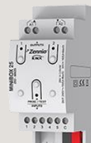
MINiBOX 25 (Ref. ZIO-MN25) Actuador multifunción con 2 salidas (16A) y 5 entradas analógico-digitales
