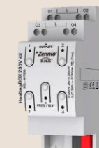
MINiBOX 25 (Ref. ZIO-MN25) Actuador multifunción con 2 salidas (16A) y 5 entradas analógico-digitales
