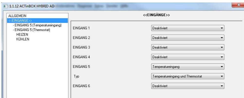
Bild 18. Thermostat ACTinBOX CLASSIC HYBRID Thermostat freigeben
