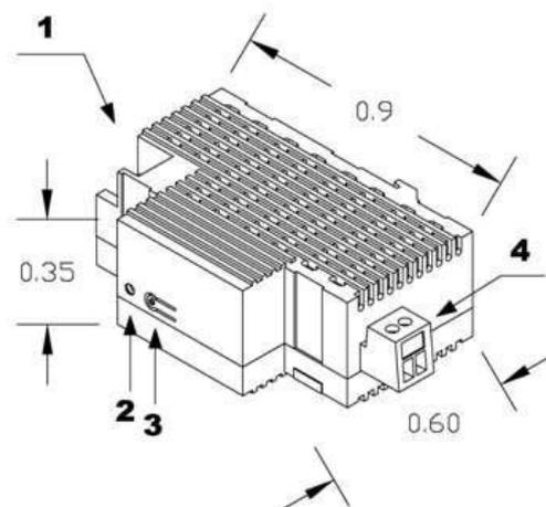
Este dispositivo no necesita de fuente de alimentación externa, pues se alimenta a través del bus KNX.
